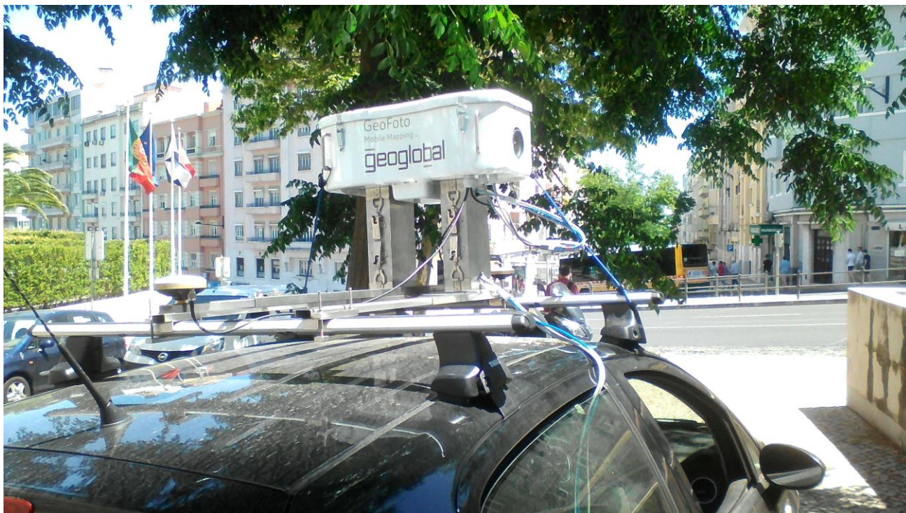
Figura 21. Estrutura do Geofoto onde se fixam as Câmaras e o GPS
